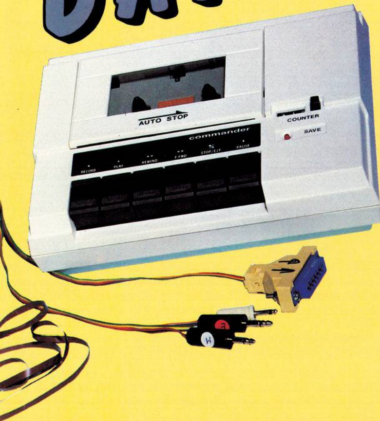
Bild 1. Die Data- sette, der Data- Kassettenrecorder und ein Eigenbau- Interface für handelsüblichen Kas- settenrecorder
