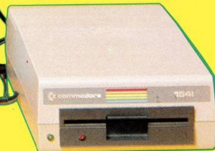
gen. Mit dem DOS im Floppy 1541 lassen sich leider ohne größeren Aufwand keine höheren Transferraten erreichen. Aber immerhin, es geht.
