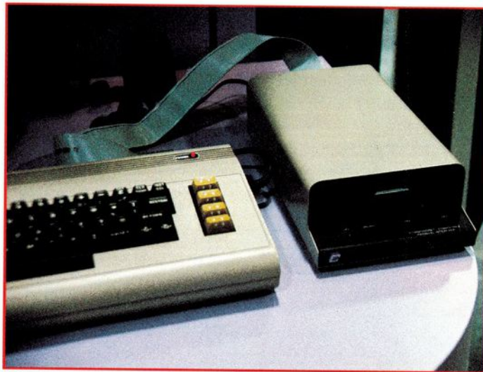
Bild 2. Das Laufwerk C-321P von Concorde für 389 Dollar ist bis zu zehnmal schneller als die Floppy VC 1541.
