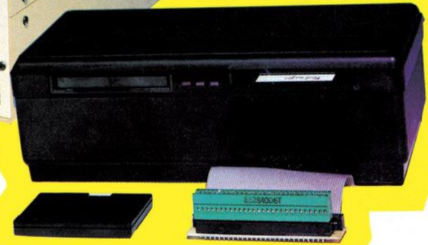
Oben das Wafertape-Laufwerk mit dem Endlosband. Unten das Einzellaufwerk für den VC 20/C 64.
