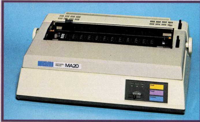
Bild 1. Der Petal MA20 Typenraddrucker
