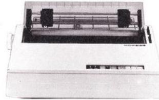
Pufferspeicher 5 KByte bzw. 13 KByte. Druckgeschwindigkeit 13 Zeichen/sec., Schwarz-Rotdruck, Proportionaldruck, Copy-Funktion, bidirektional, mit Centronics-Schnittstelle .....DM 1648,— mit Centr.-Schnittstelle **und**
