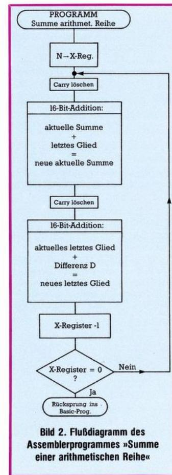
Bild 2. Flußdiagramm des Assemblerprogrammes »Summe einer arithmetischen Reihe«
