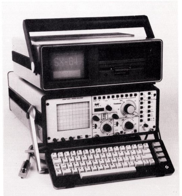
Das tragbare Maßdatenerfassungssystem mit SX 64
