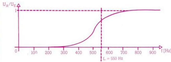
Frequenzgang eines Hochpaßfilters mit einer Eckfrequenz (das ist die Frequenz, bei der die Filterwirkung von Sperren nach Durchlassen übergeht) von zirka 550 Hz.
