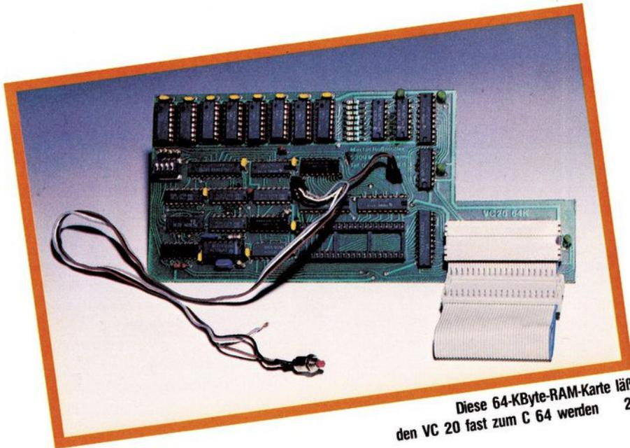
Diese 64-KByte-RAM-Karte läßt den VC 20 fast zum C 64 werden 26
