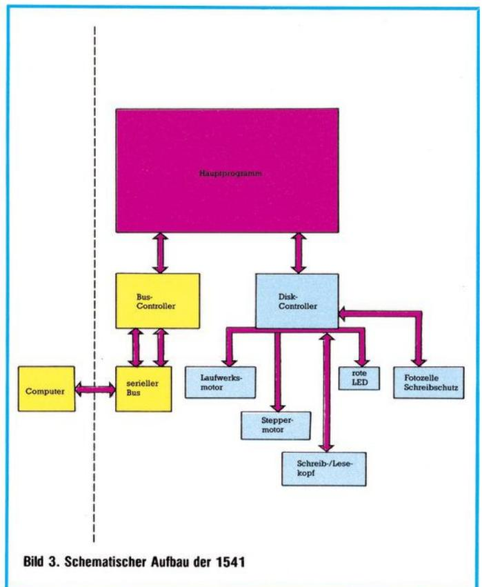
Bild 3. Schematischer Aufbau der 1541
