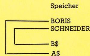
Bild 2. So sieht der Speicher nach dem Befehl A\$="BORIS":B\$="SCHNEIDER" aus. Oben stehen die Strings, unten die dazugehörigen Descriptoren.
