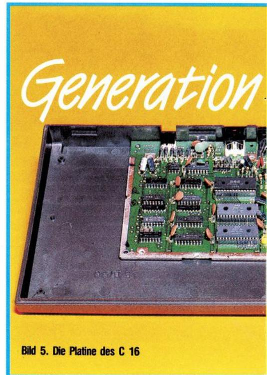
Bild 5. Die Platine des C 16
