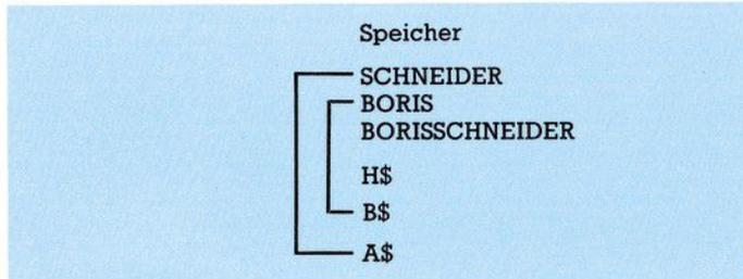
Bild 8. Die Garbage Collection ist beendet, der Restmüll am Ende des Stringspeichers kann einfach überschrieben werden.
