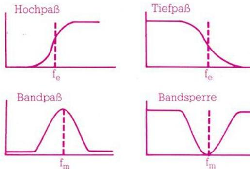
Beschrieben werden Filter durch: Eckfrequenz  $f_e$  (Hoch- und Tiefpaß) Mittelfrequenz  $f_m$  (Bandpaß und Bandsperre) Steilheit: Das ist der Grad der Steigung des Frequenzgangs beim Übergang zwischen sperrendem und durchlässigem Zustand. Resonanz siehe Zeichnung
