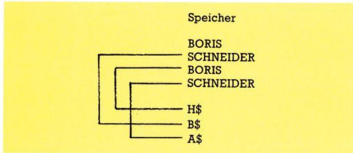
Bild 4. Nach AS=B\$ ist der erste Müllstring entstanden
