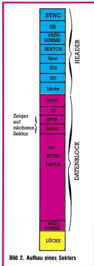
Bild 2. Aufbau eines Sektors
