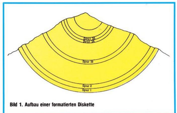
Bild 1. Aufbau einer formatierten Diskette
