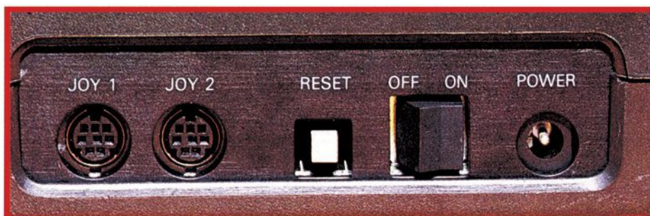
Bild 3. Der C 16 von der Seite. Deutlich zu erkennen der weiße Reset-Schalter und die Mikro-Joystickbuchsen. Auch der Netzteil-Anschluß wurde geändert.
