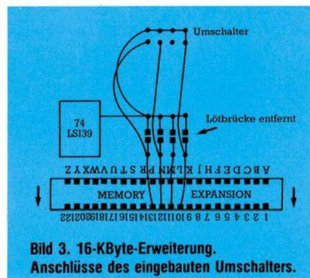
Bild 3. 16-KByte-Erweiterung. Anschlüsse des eingebauten Umschalters.
