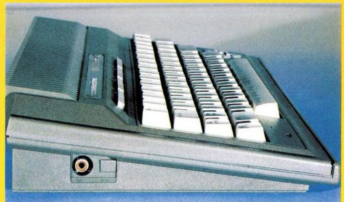
Bild 6. Der HF-Ausgang ist an der Seite angebracht. Der zweite abgedeckte Ausgang ist in der amerikanischen Version ein Kanal-Umschalter.
