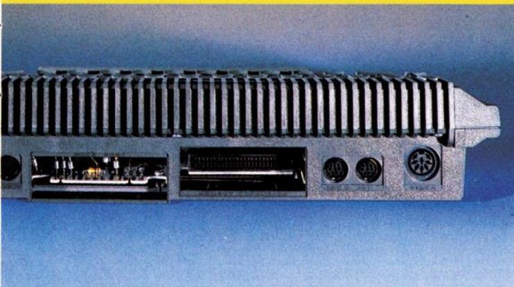
den Netzanschluß, den seriellen Port, den veränderten Datenset-Anschluß, den expansion-Port, die Joystickanschlüsse und den Videoanschluß.
