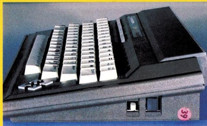
Bild 4. Neben dem Netzschalter ist ein Resetknopf angebracht
