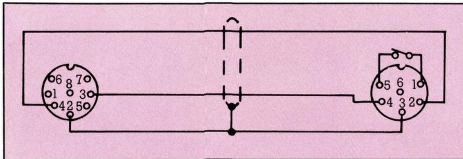
Bild 4. Anschluß eines SW-Fernsehgerätes oder eines monochromen Monitors
