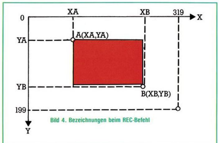
Bild 4. Bezeichnungen beim REC-Befehl
