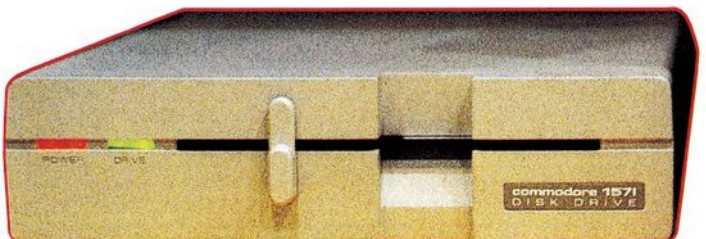
Bild 3. Das neue Diskettenlaufwerk 1571 in flacher Bauweise hat eine Speicherkapazität von bis zu 410 KByte ▼
