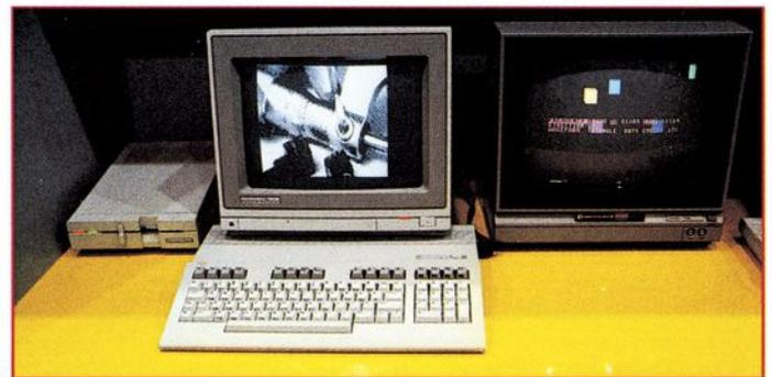
Bild 2. Das Gesamtsystem, bestehend aus PC 128, Diskettenlaufwerk 1571, Monitor 1902 und 1702
