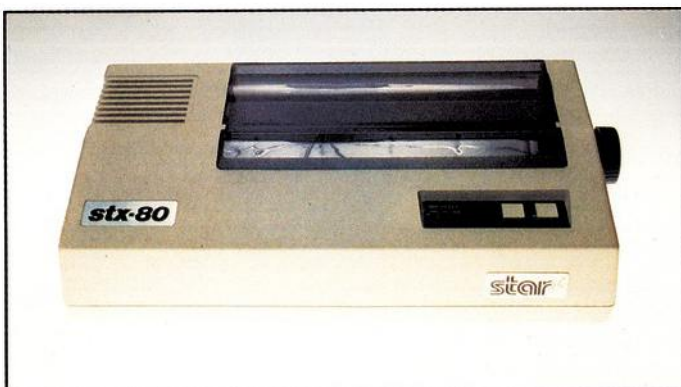
Bild 9. Star STX 80, ein leistungsfähiger Thermo-Drucker
